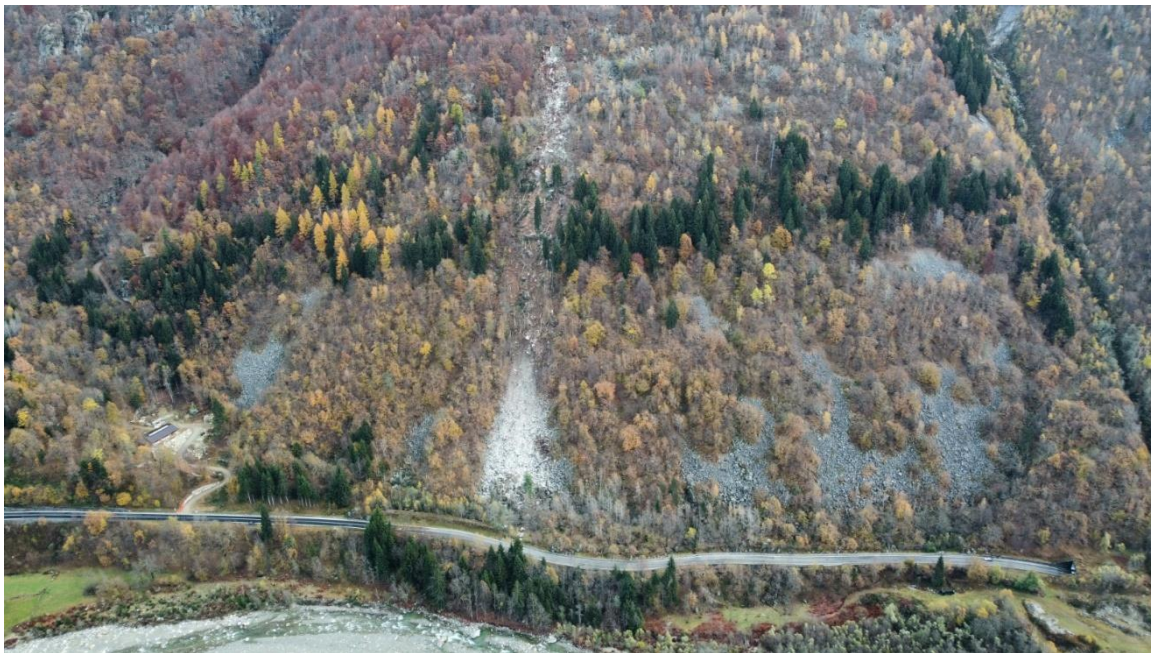
Figura 1 – Fotografia da drone: vista frontale del corpo frana dell’evento avvenuto nel novembre 2021; in basso al centro si nota il rilevato preesistente, mentre in basso a destra si intravede la strada chiusa a senso unico alternato
